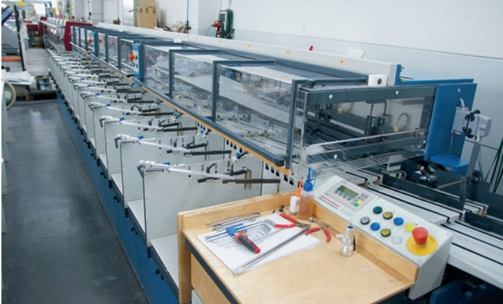
Eine generalüberholte Zusammentragmaschine tb sprint mit 15 Stationen ...
