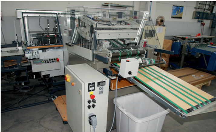
... und die neue Heft-Falz-Schneid-Maschine tb sprint 303 QSM mit Stanzmaschine tb 503 von Theisen & Bonitz sind seit Februar 2016 für eine perfekte Broschürenfertigung bei der Gwizdalski Druckverarbeitung in Betrieb.
