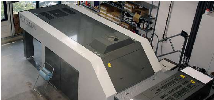
Highlight der neuen Lithrone G40 bei Fritsch ist das direkt in die Auslage integrierte H-UV-Trocknersystem, das eine sofortige Weiterverarbeitung zulässt.
