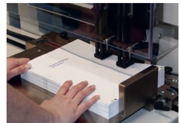
Der Bohrvorgang wird eingeleitet durch das Einlegen des Papierstapels. Als Bohrunterlage dient ein Bohrband, das saubere Löcher bis zum letzten Bogen garantiert. Danach wird dieses weiter getaktet. Gebohrt wird per Fußschalter.
