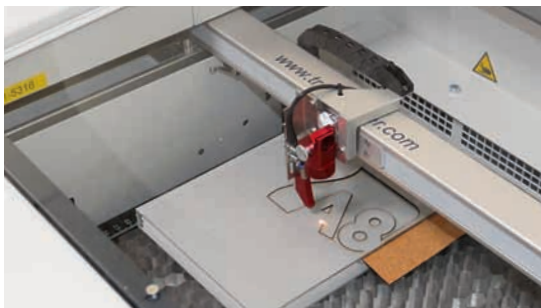
Der schnelle Lasergravierer von Trotec, Speedy 100, hat eine Gravurgeschwindigkeit von 2,8 m/s und eine Beschleunigung von 4g.
